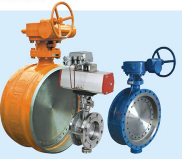
高性能三偏心双向硬密封蝶阀，其特征在于：所述阀座密封圈由软性T形密封环两侧多层次不锈钢片组成。阀板与阀座的密封面为斜圆锥结构，在阀板斜圆锥表面堆焊耐温、耐蚀合金材料；固定在调节环压板之间的弹簧与压板上调节螺栓装配一起的结构。
